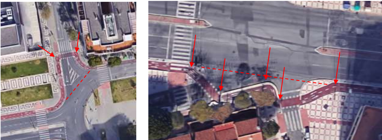
Figura 7. Ejemplo de carril bici con sinuosidad muy alta. En rojo se han marcado las curvas innecesarias y la dirección lógica de la vía. Fuente: Elaboración propia.
