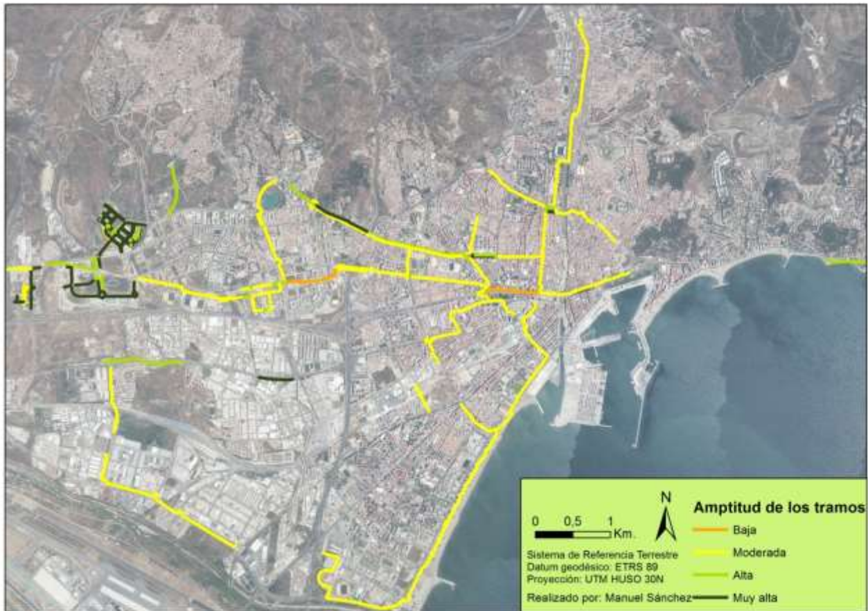
Figura 8. Mapa del índice de la ciclabilidad para los carriles bici de Málaga. Fuente: Elaboración propia.
