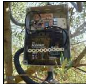
Figura5: Componentes electrónicos de la trampa
