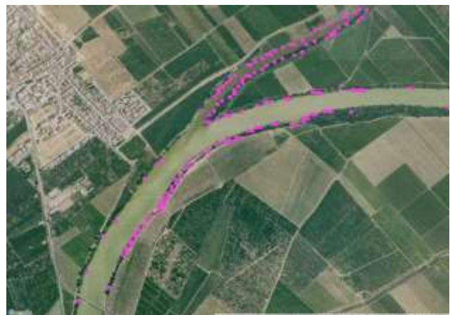
Figura 1. B Error de Comisión: ribera del río Guadalquivir incorrectamente clasificado como humedal
