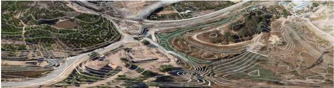
Figura 7. Integración de IGD - Curvas de Nivel. Fuente: Producción propia.
