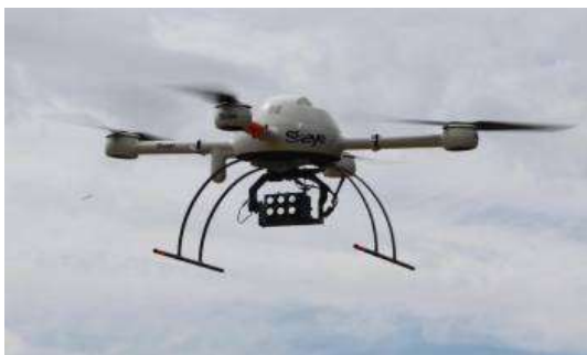
Figura 8. RPAS MD4-1000 con cámara multispectral de seis canales. Fuente: Producción propia.
