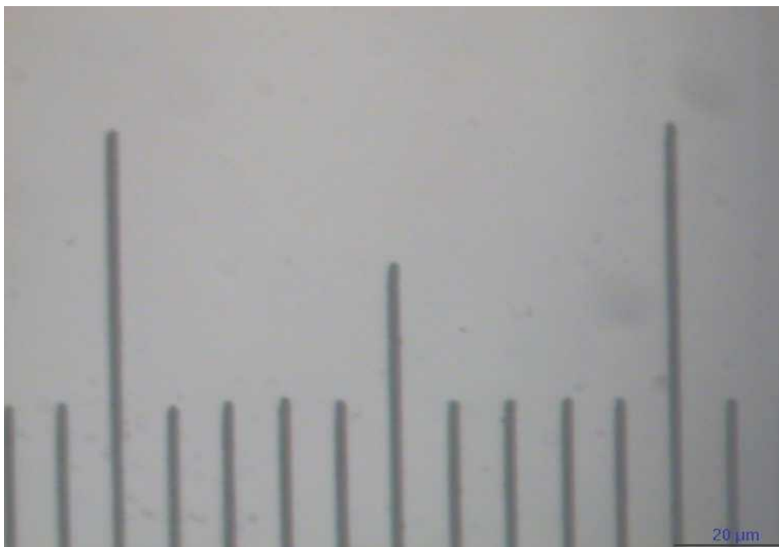
Imagen V.1: Ajuste de escala con el patrón micrométrico
