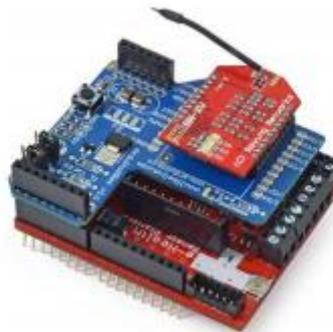
**Figura 14: Placa e-Health junto a la placa de comunicación y el módulo WiFi**
