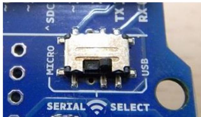
*Figura 71: Modo de funcionamiento en USB*
