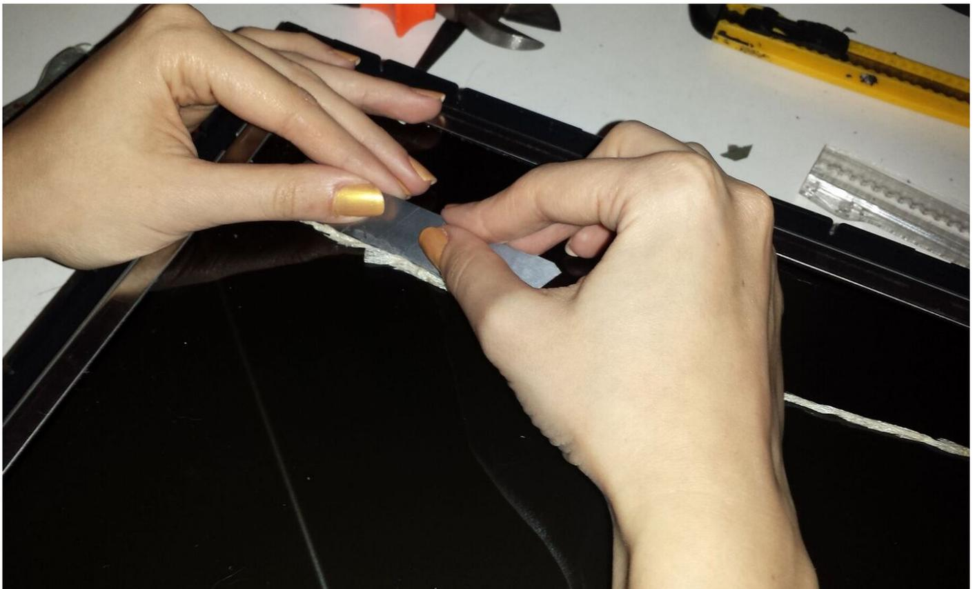
Tras retirar el filtro, la pantalla se veía blanca, como se muestra a continuación. Sería entonces cuando, con la ayuda de la hoja de un cúter fui ir retirando cuidadosamente el pegamento que mantenía unido el filtro.
