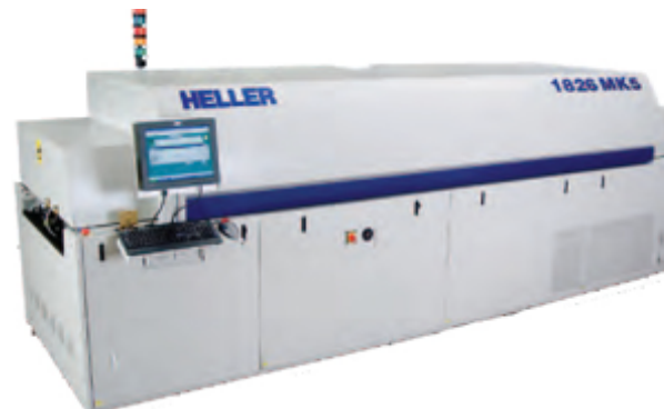
Horno de soldadura
