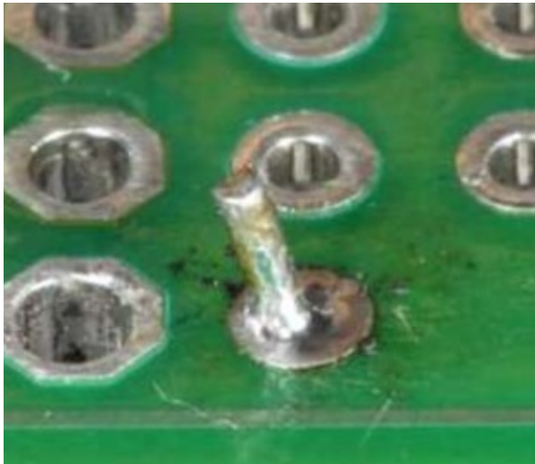
Ejemplos de soldadura insuficiente
