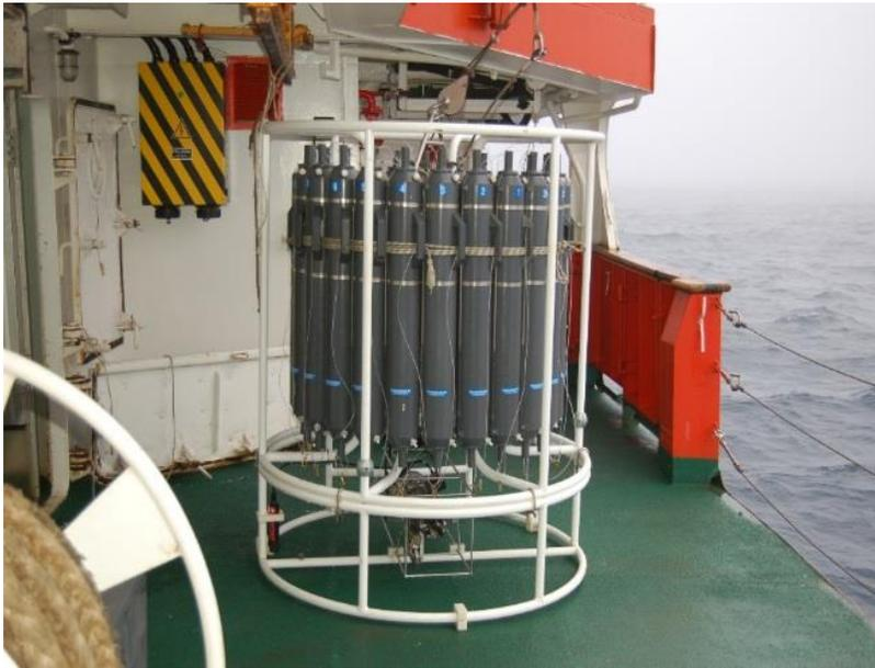
**Figura 4.9** Roseta oceanográfica con botellas Niskin y CTD.
