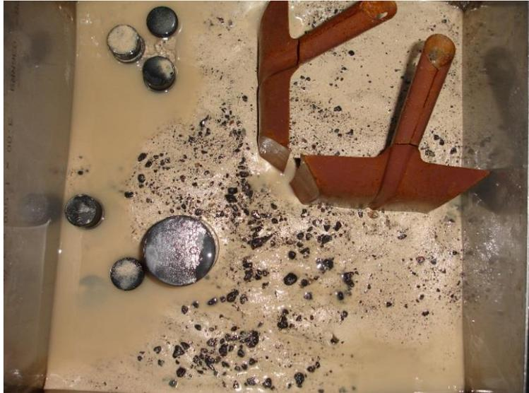
**Figura 4.5** Sedimento en el cajetín de muestreo, los círculos negros son los tapones de los corer.
