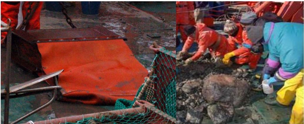
**Figura 4.3** Draga de roca y material procedente de un arrastre con dicha draga.
