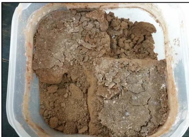
Figura 60. Formación precipitado en la zona superior del suelo (SLC ST<sub>1</sub>)
