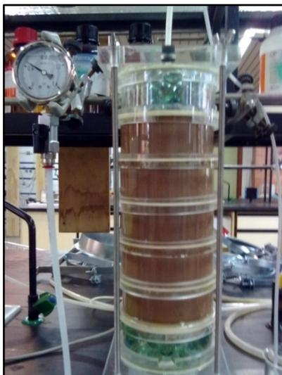
Figura 9. Determinación de la conductividad hidráulica.
