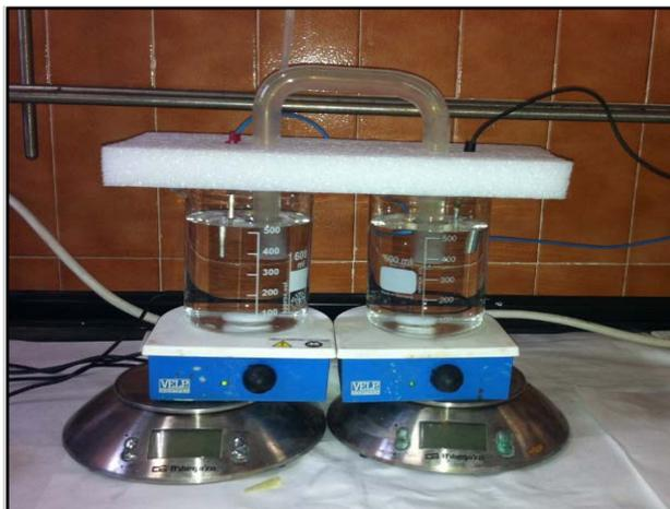
Figura 14. Sistema experimental ensayo influencia de la corriente eléctrica en una disolución de  $\text{Na}_2\text{EDTA}$ .
