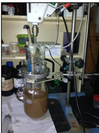
Figura 11. Sistema experimental donde se realizan los ensayos en tanque agitado.
