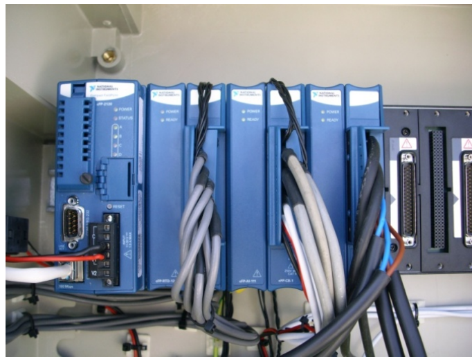
Figura 4. Sistema Compact FieldPoint. Dispone de un controlador con interfaz Ethernet y de módulos para los distintos tipos de señales
