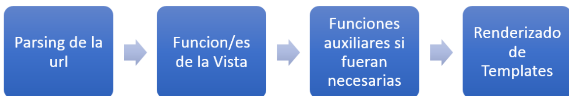
Figura 3.24: Esquema funcionamiento servidor web
