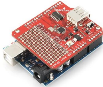
Figura 15: Conexión del Shield USB al Arduino.
