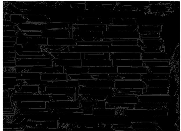
(d) Algoritmo de Canny con  $\text{threshold}=0.08$  y  $\sigma=3$
