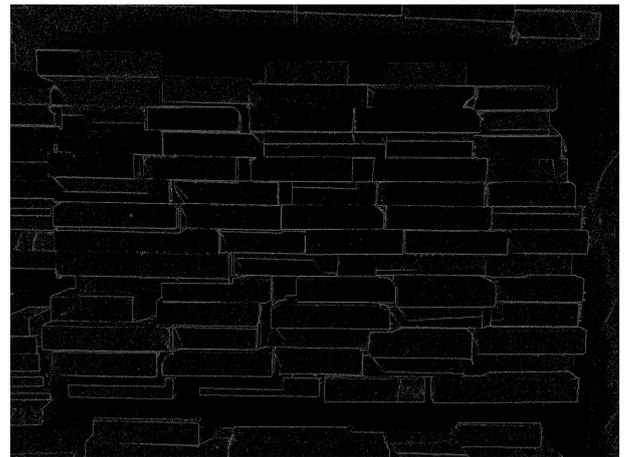
(b) Algoritmo de Sobel con  $\text{threshold}=0.045$
