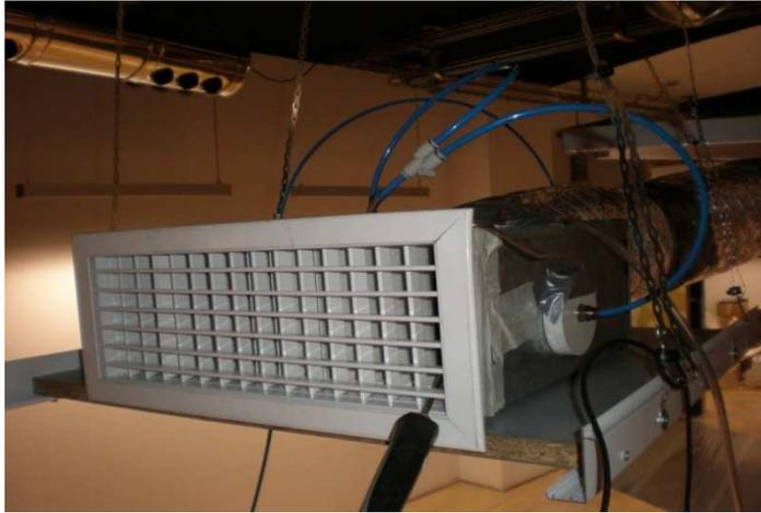
Fig. 3.3. Fotografía del montaje experimental del difusor de pared.
