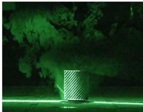
Fig. 2.12. Objeto de referencia utilizados en la calibración del difusor de suelo.
