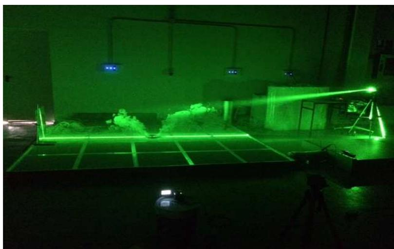
Fig. 2.7. Fotografía para una visión general del montaje experimental esquematizado en la Fig. 2.6 para visualización del flujo de aire mediante fuente láser y sin la carpa de lona.
