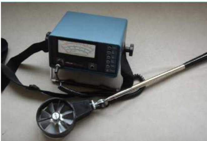
Figura 5. Anemómetro y caudalímetro para determinación de caudal y renovaciones de aire.
