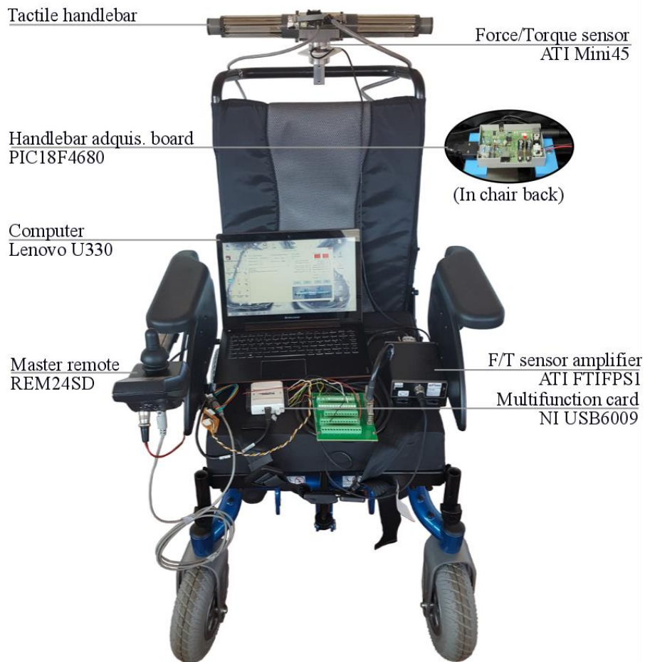
Figura 7. Montaje experimental. Se ha añadido un ordenador y un sensor de fuerza al conjunto para la extracción de datos experimentales.
