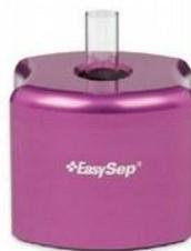
**Figura 23.** Imagen del imán utilizado para la separación celular inmunomagnética.
