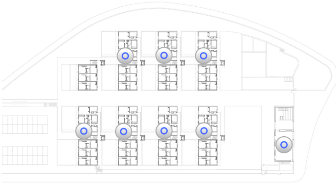
Figura 32: Disposición del equipamiento en la planta primera
