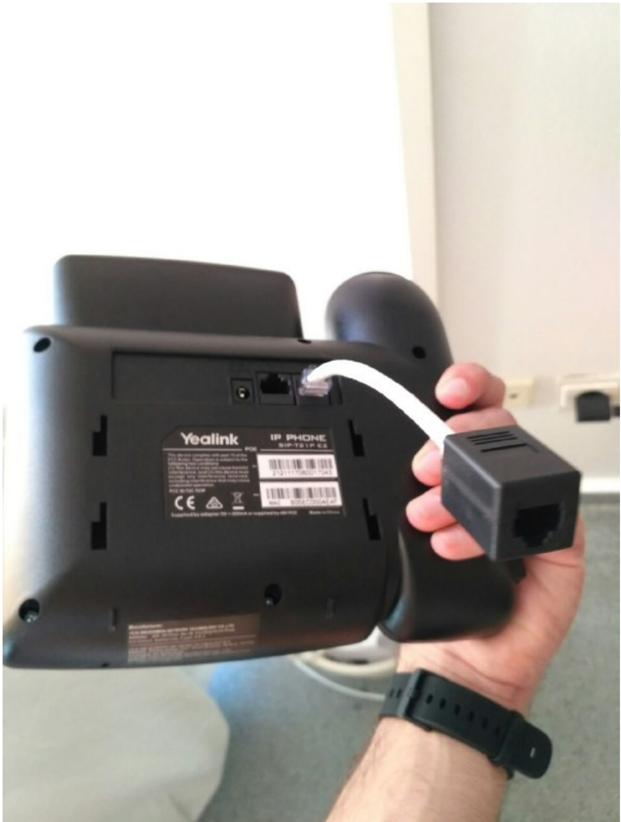
Figura 38: Sistema empleado para extender la toma del switch
