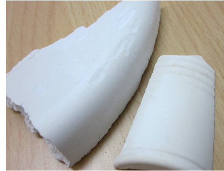
Dos pequeñas muestras de material: la escayola a la derecha con muestras de arañazos, la resina acrílica a la izquierda sin aparentes muestras después de sufrir la misma agresión.
