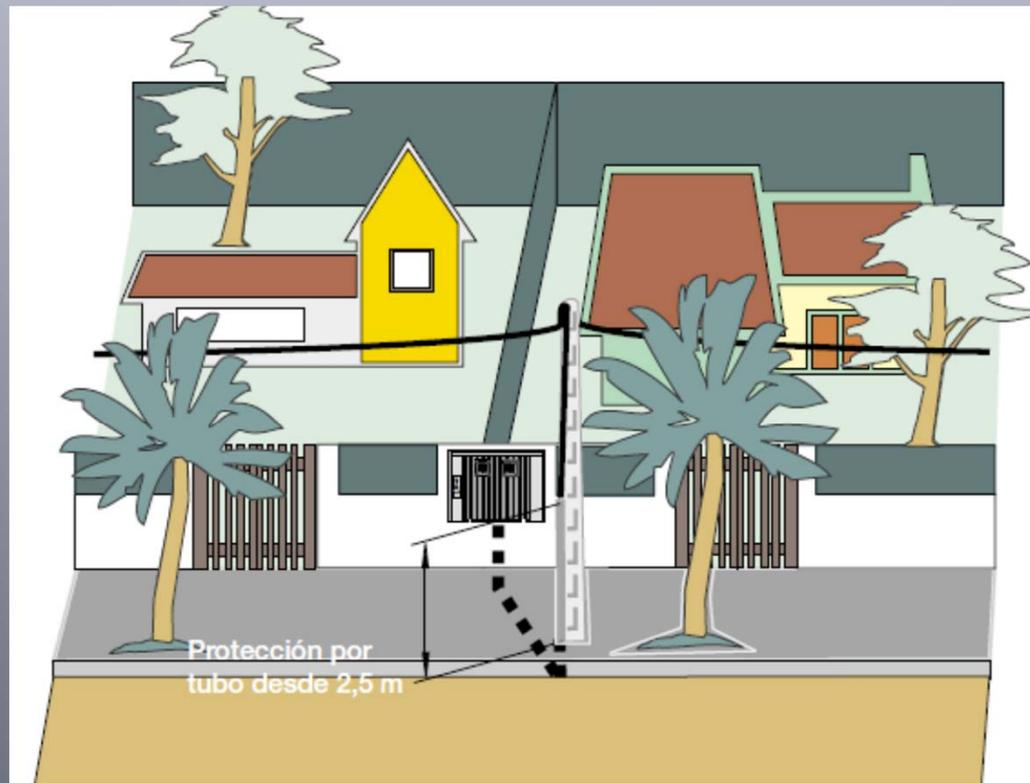
Fig. D1-010: tipo de acometida aérea para dos abonados.
