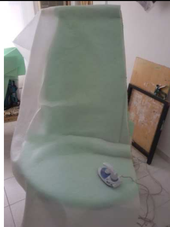
Planchado de la guata termoadhesiva y detalle de las capas constructivas
