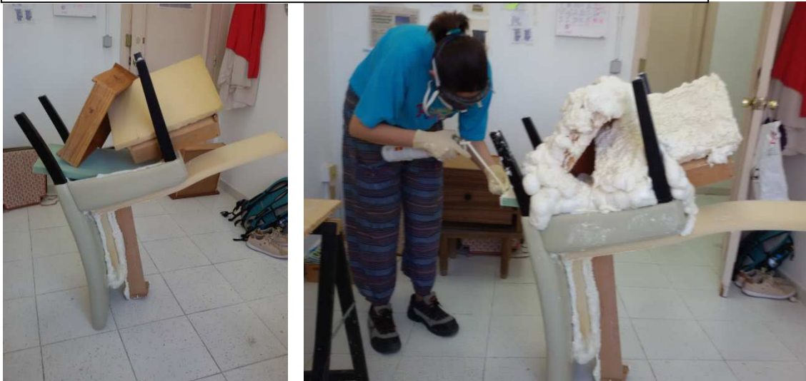
Pruebas de corte y puesta a la intemperie para la oxidación de la cobertura
