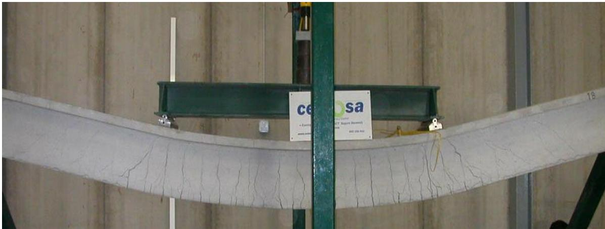
Si la sección está muy débilmente armada, el diagrama del hormigón será pequeño y muy concentrado, produciéndose el agotamiento de la sección por agotamiento del acero (Fig. 3-3). Por el contrario, si la cuantía de acero es grande (secciones sobreamadas) el diagrama se extenderá bajando por la sección, produciéndose el agotamiento por compresión del hormigón (Fig. 3-4).
