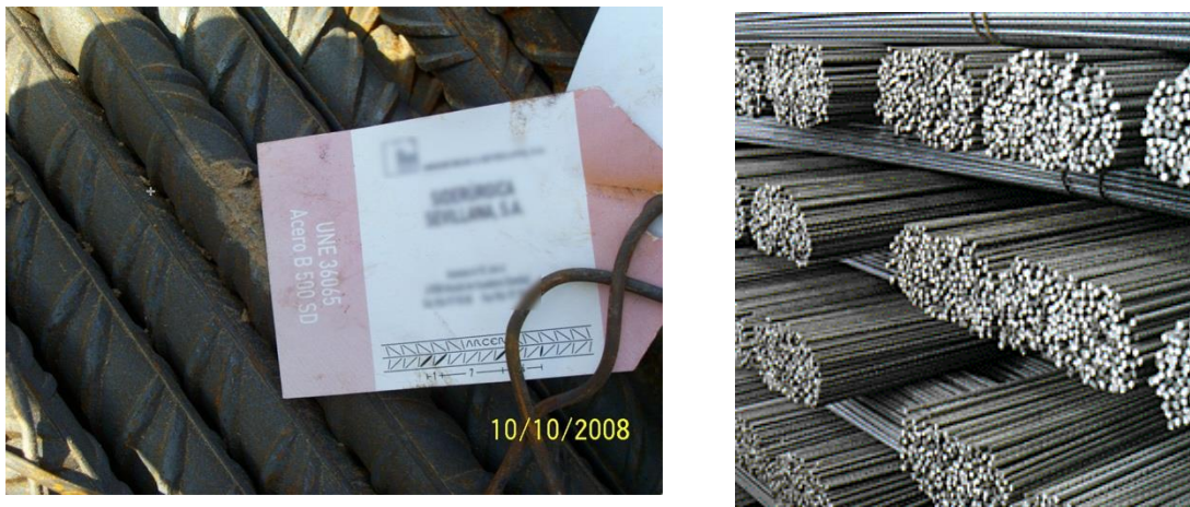
Figura 13. Acopio de armaduras corrugadas en obra y almacén.
