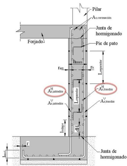
Figura 18. Armadura horizontal en muros
