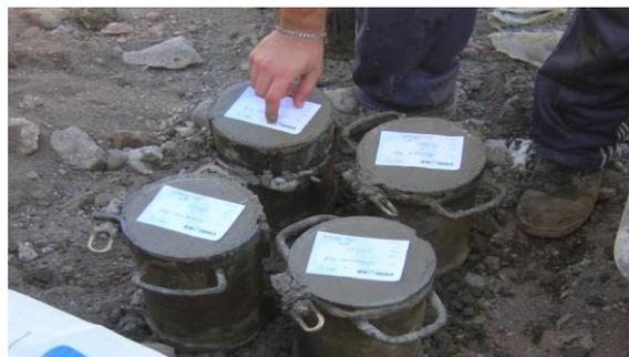
Fabricación de probetas en obra
