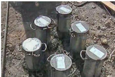
Figura 27. Toma de 6 probetas de una amasada
