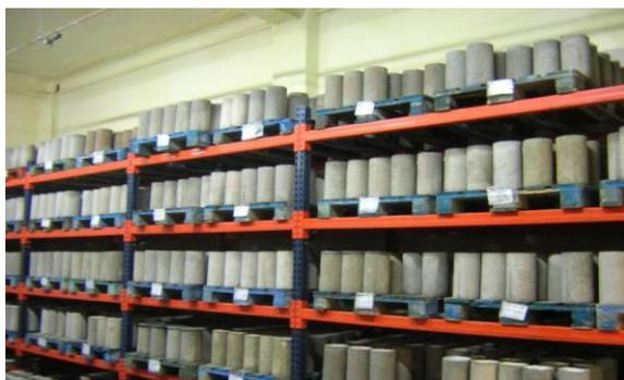
Conservación en cámara húmeda del laboratorio de ensayos
