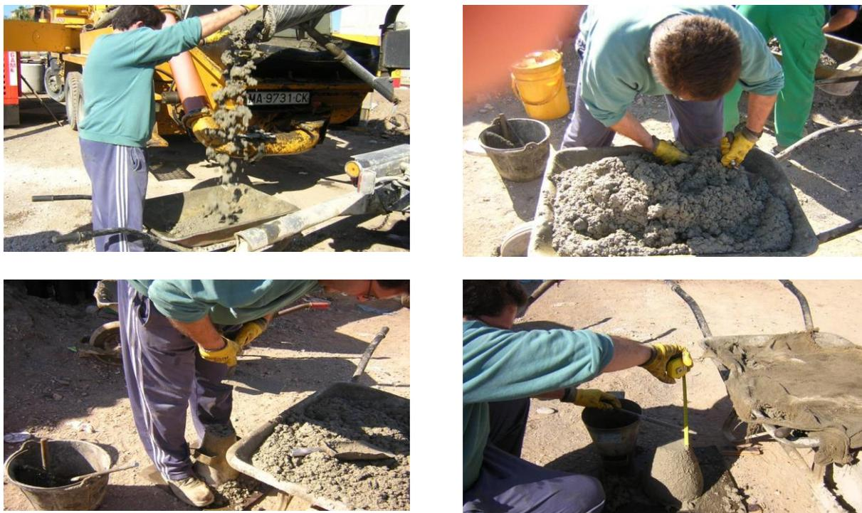
Figura 6. Ensayo del cono de Abrams para la medida de la consistencia
