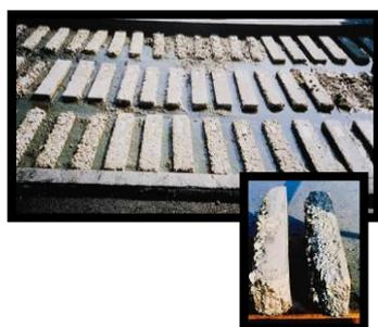
Figura 2. Degradación del hormigón en presencia de sulfatos
