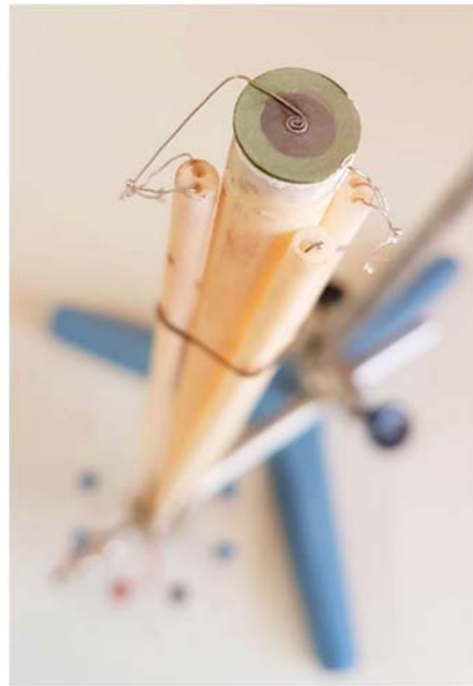
Figura 1.39. Esquema y fotografía de la celda para el estudio del rendimiento de una SOFC.
