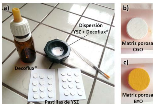
Figura 4.16. Fotografía de a) dispersión de YSZ + Decoflux ®4 preparada en un mortero de ágata para pintar las matrices porosas sobre las pastillas de YSZ. Fotografía de dos pastillas de CGO con matrices porosas de b) CGO y c) BYO.
