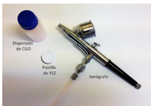
Figura 4.30. Fotografía del frasco con la dispersión de partículas de CGO, del sustrato de YSZ y del aerógrafo utilizado para la preparación de las capas protectoras.
