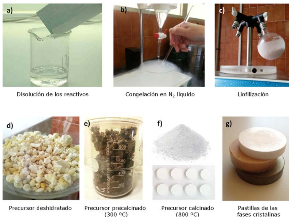
Figura 1.23. Fotografías que ilustran las distintas etapas transcurridas para obtener un sólido mediante el proceso del precursor liofilizado.
