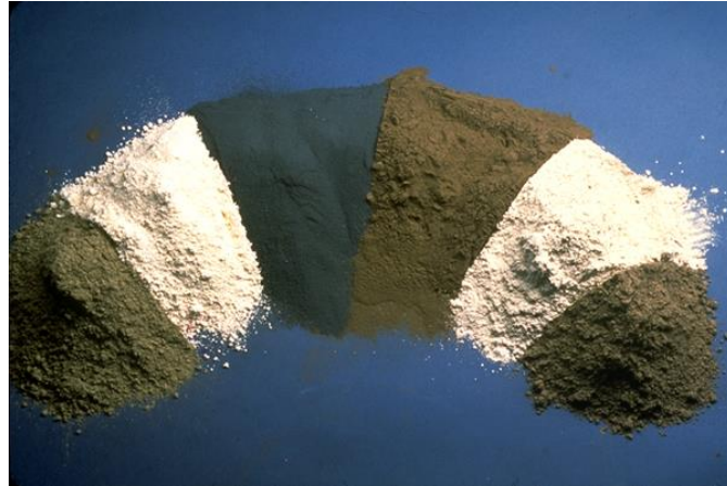
Figura 4. De izquierda a derecha: cenizas volantes (Clase C), metacaolín, humo de sílice, cenizas volantes (Clase F), escoria y esquisto calcinado.
