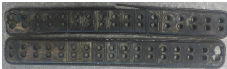
Figura 17. Juntas de estanqueidad desmontadas.
