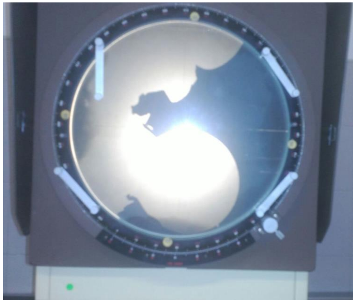
Figura 24. Muestra de la pantalla del proyector de perfiles en proyección episcópica.
