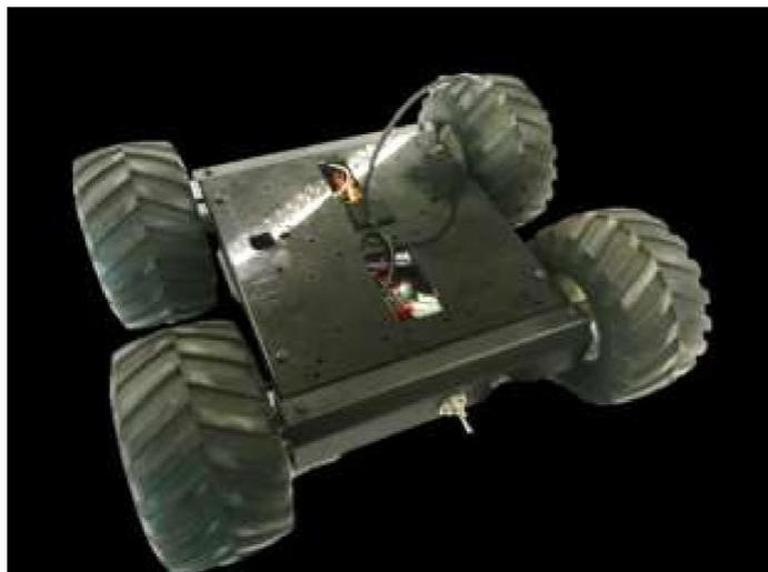
Figura 1.1 - Robot Móvil Krobot
