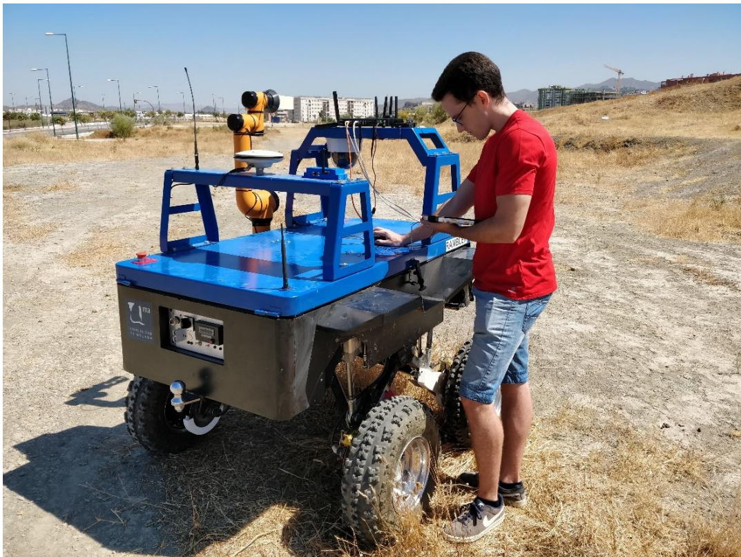
Figura 2: Realización de pruebas sobre terreno abrupto.
