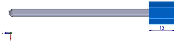
Figura A.126: Extrusión del cuerpo hexagonal del sensor.
