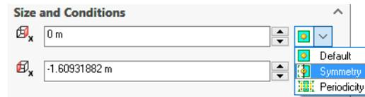
Figura B.17: Condición de simetría.
