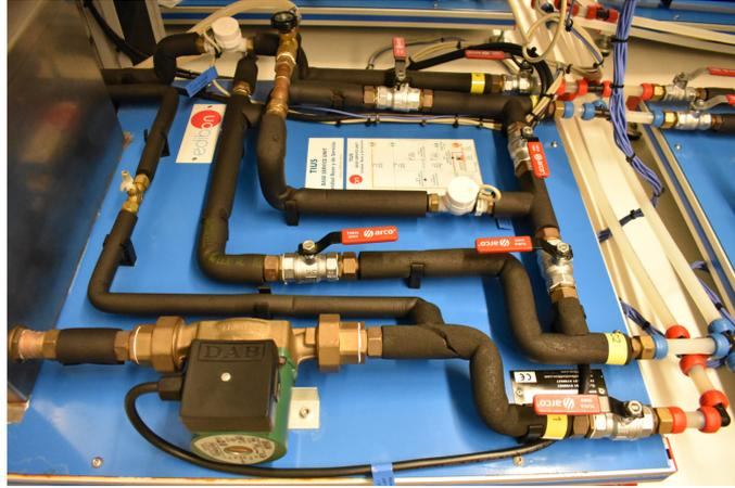
Figura 3.4: Válvulas dispuestas para flujo en contracorriente.
