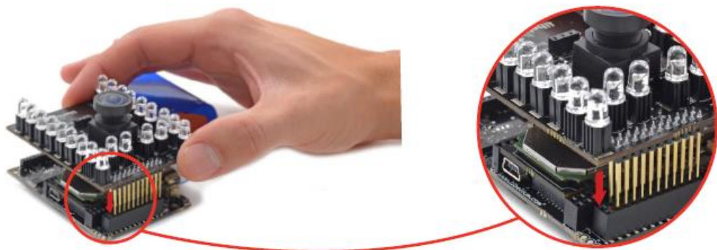
Figura 3.6. Conectar Videocámara sensor a la Waspote
