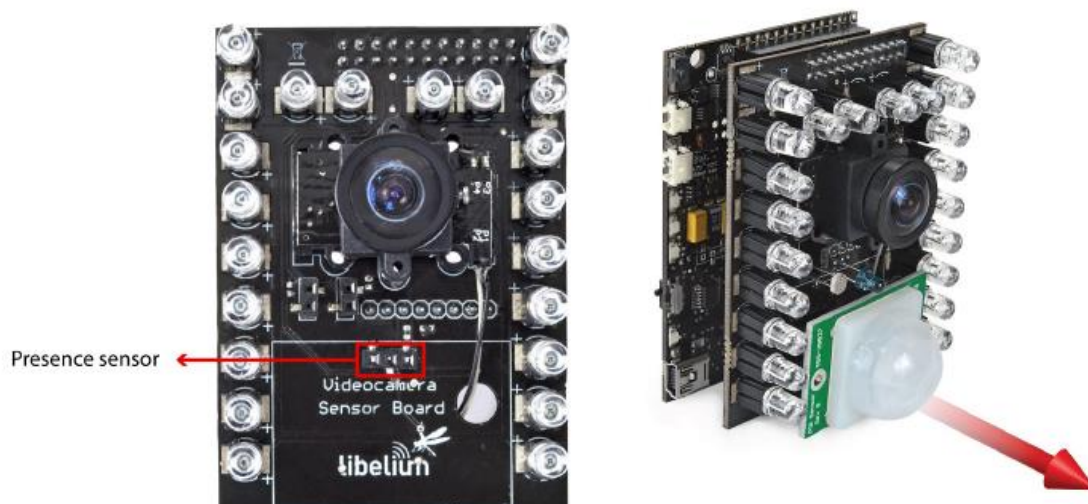
Figura 3.7. Conexión de sensor de presencia PIR a la placa de la Videocámara.
