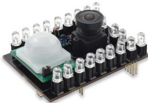
Figura 2.6. Videocámara, con todos los sensores necesarios conectados.
