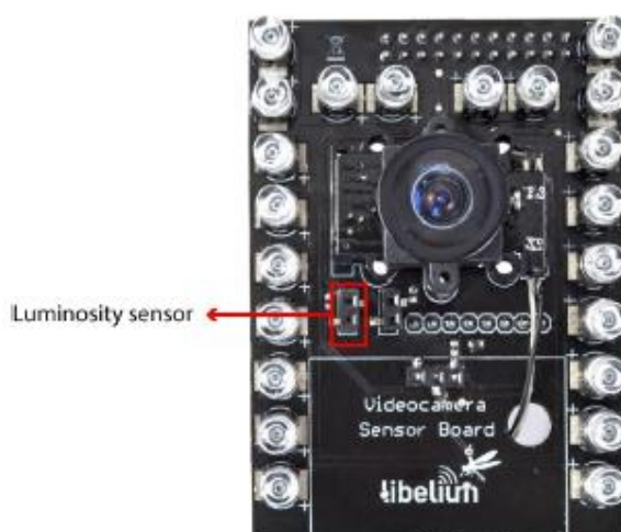
Figura 3.9. Conexión de sensor de luminosidad en la placa de la Videocámara.
