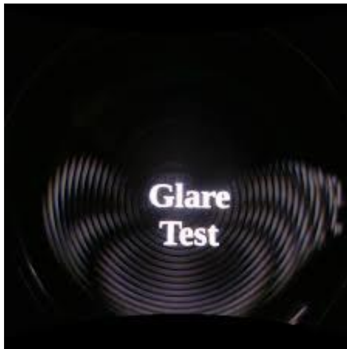
Figura 2.6 : Deslumbramiento producido por el Glare en una lente Frenel.
