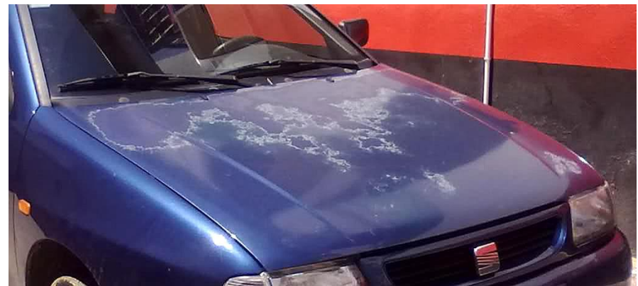
Fotografía de internet como ejemplo de pintura en mal estado
