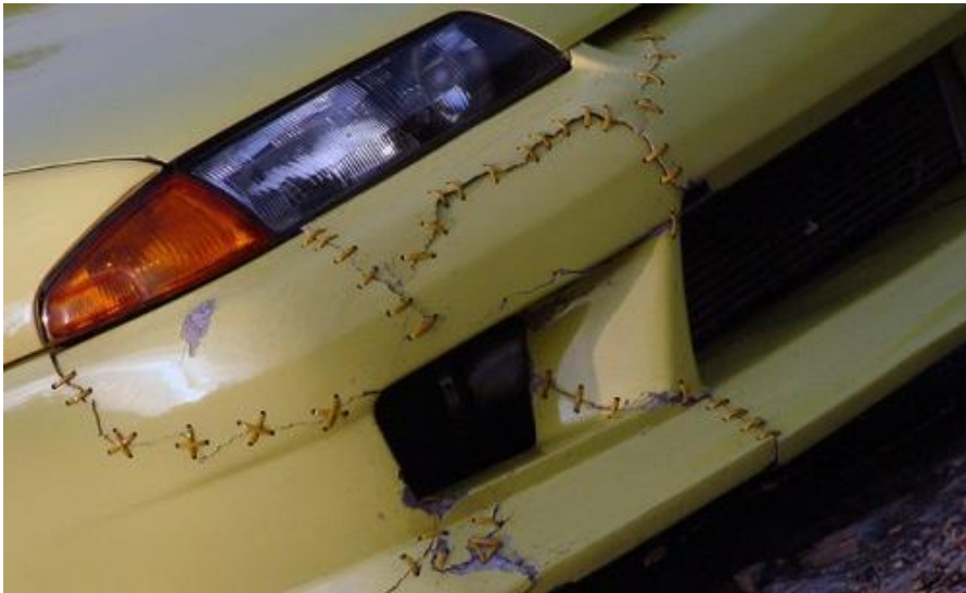
Fotografía de un Nissan Skyline GT-R (R32), donde podemos apreciar la forma común de solucionar una rotura de parachoques en un coche de drift
