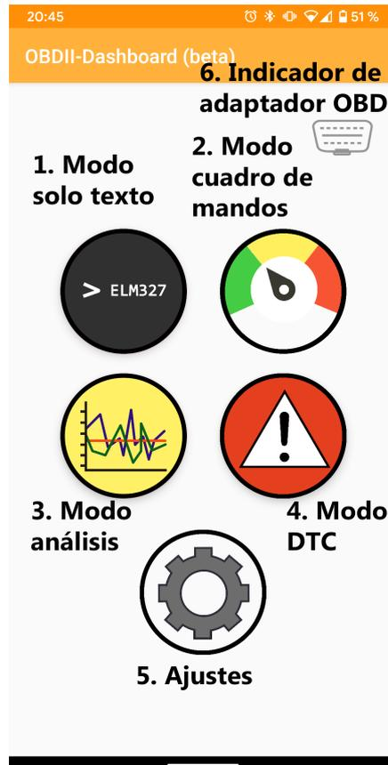
**Figura A.7:** Menú principal de la aplicación con el indicador de adaptador OBD en gris, sin conexión OBD. Modo sin conexión.
