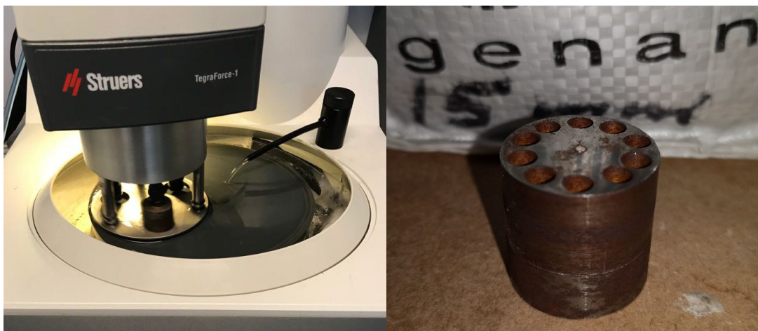
Figura 3.3: A la izquierda, la pulidora planetaria y a la derecha, el utillaje donde se introducen las muestras a pulir.
