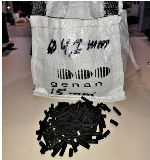
Figura 3.1: Muestras en bruto de pellets de caucho semivulcanizado, procedentes del reciclado de neumáticos fuera de uso obtenidos por la empresa Genan.
