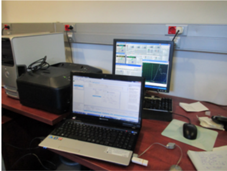
Figura 5.16: Adquisición de datos simultánea de los LVDT con el y la máquina de ensayo mediante los softwares P2K y NI SignalExpress
