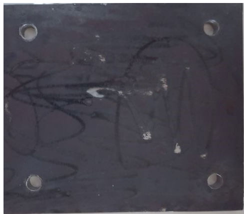
Figura 5.6: Placa superior de sujeción del utillaje del empotramiento de la pala obtenida a partir de mecanizado
