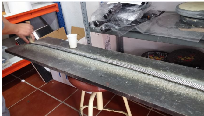
Figura 4.11: Aplicación de resina sobre el Braiding .
