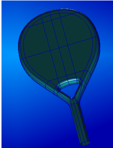
Figura 9.3: Geometría final del modelo en elementos finitos
