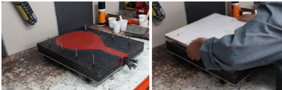
(c) Refuerzo contra la expansión lateral atornillado. (d) Disposición del refuerzo superior
