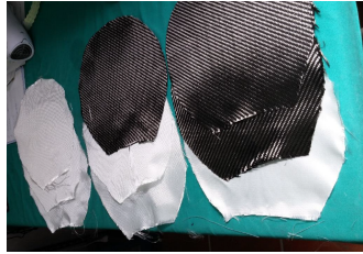
Figura 4.8: Capas de fibra de vidrio y carbono cortadas a su forma final para diferentes palas.
