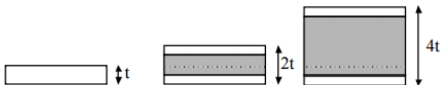
Figura 6.5: Ejemplo de aumento de la rigidez de una estructura tipo Sandwich
