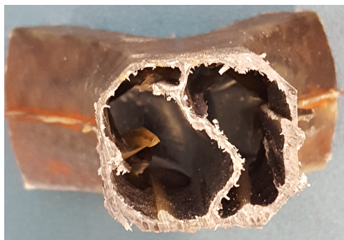
(a) Irregularidad en el contacto de tubos en el mango (b) Corte A-A' de detalle de geometría del mango
