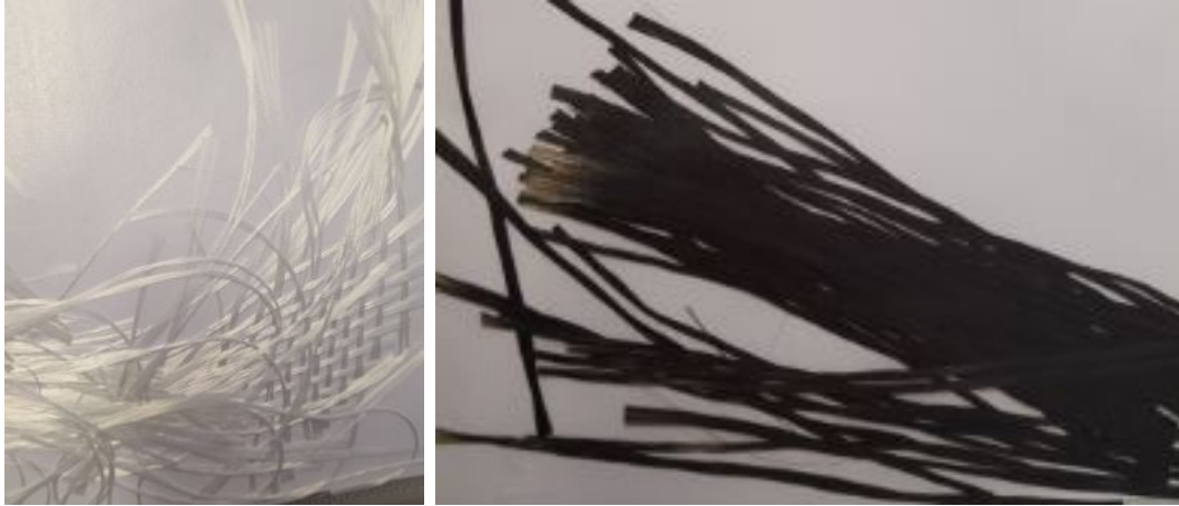
(a) Hilos de fibra de carbono (b) Hilos de fibra de vidrio obtenidos del braiding para el cálculo de % de volumen
