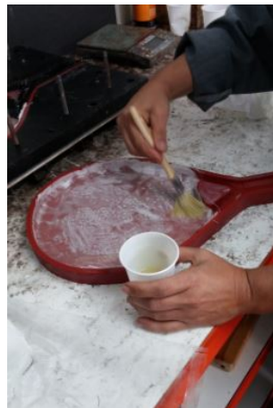
Figura 4.9: Aplicación de resina sobre las primeras capas de fibra de vidrio.
