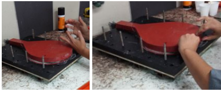
(a) Posicionamiento de la parte simétrica del molde (1). (b) Posicionamiento de la parte simétrica del molde (2).
