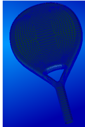
Figura 9.15: Modelo en elementos finitos final, mallado realizado
