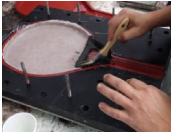
Figura 4.10: Aplicación de resina sobre las primeras capas de fibra de vidrio.
