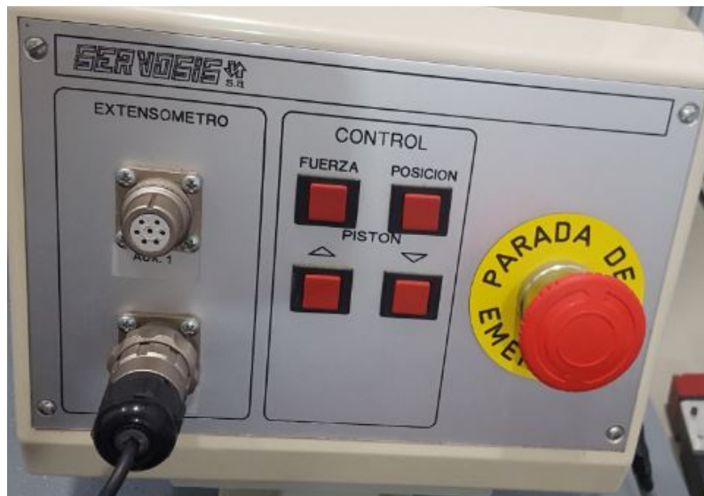
Figura 5.13: Panel de control manual de movimiento de la máquina de flexión
