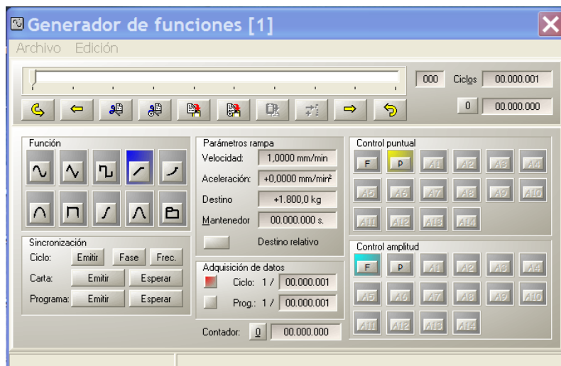
Figura 5.12: Pantalla de control de posicionamiento y velocidad de la máquina de flexión
