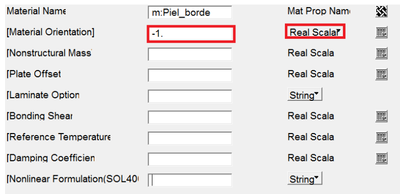
Figura 9.18: Introducción de la orientación en las propiedades en función de un vector en Patran
