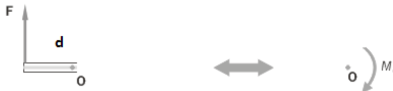
Figura IV.1 Aplicación de carga F para conseguir momento torsor M
