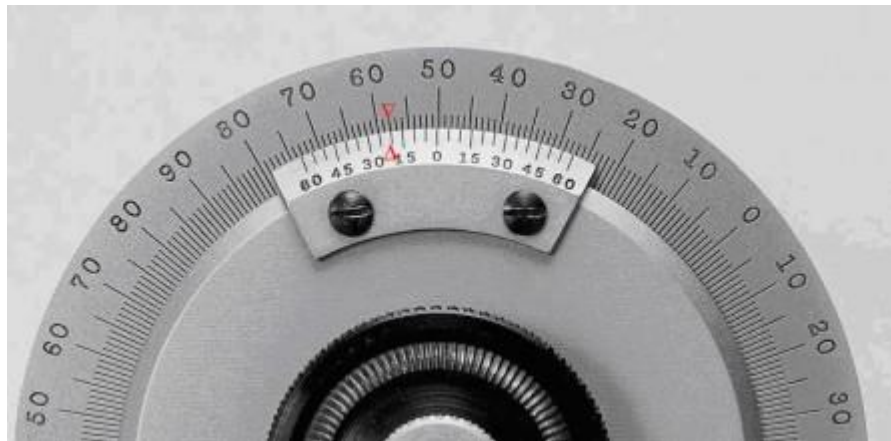
Figura 5.4 Goniómetro con escala Vernier.
