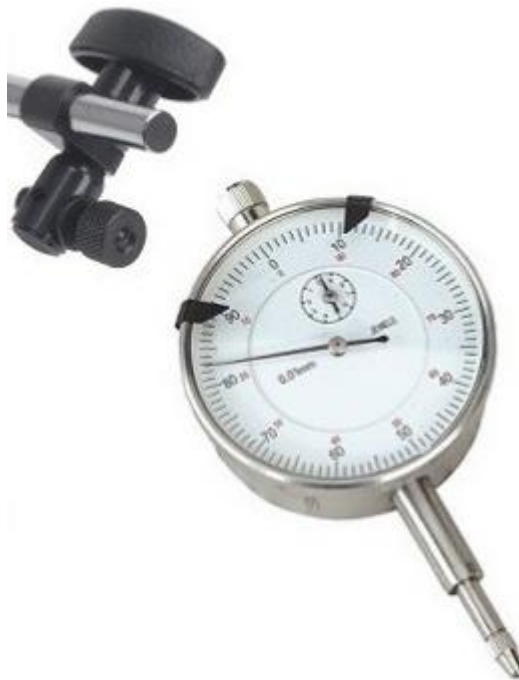
Figura 6.17 Reloj comparador y unión a barra vertical
