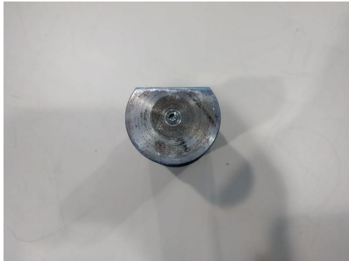
Figura 6.14 Detalle sección casquillo para entrada en orificio de pared de empotramiento.
