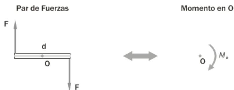
Figura 3.2 Torsión producida por par de fuerzas.
