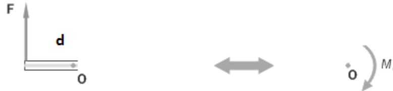
Figura III.1 Aplicación de carga F para momento torsor M
