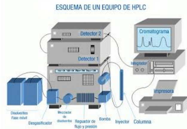
Figura 11. Esquema de un equipo de HPLC.
