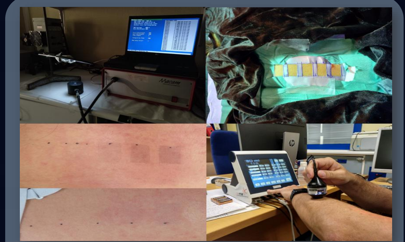
Figura 1: Espectrorradiómetro de doble monocromador MACAM SR-2271, exposición a foco de luz azul, melanogénesis tras exposición a radiación UVA (superior) y a luz azul (inferior) y análisis colorimétrico con Dermalab Skin Combo
