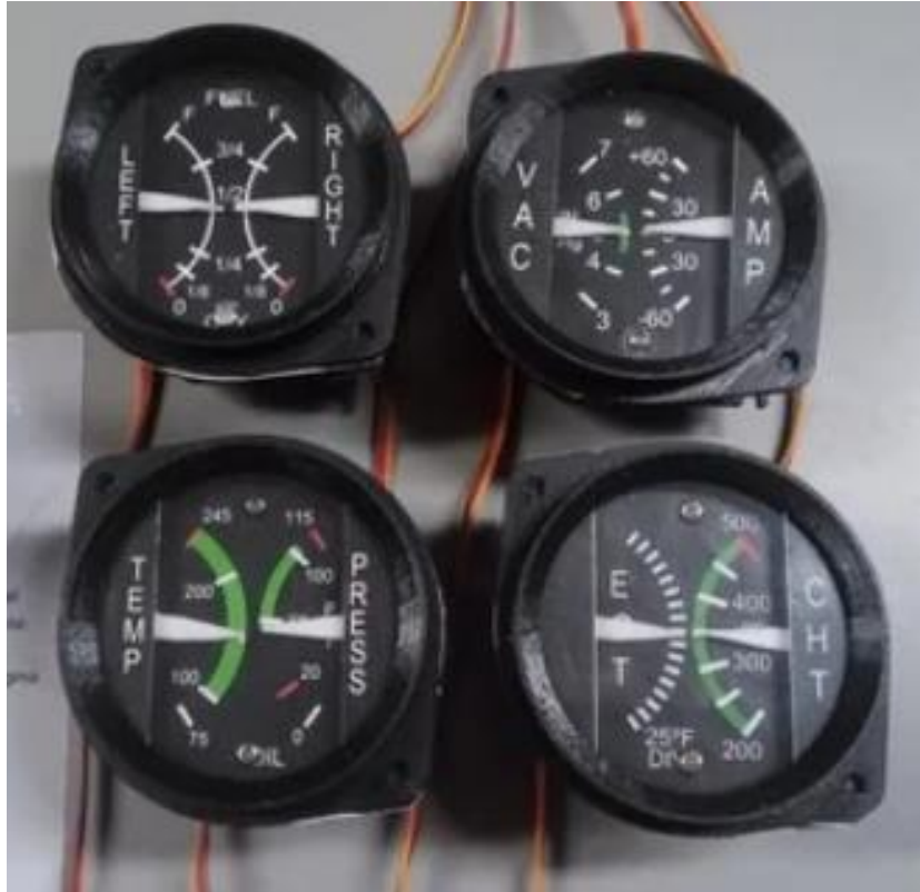
Figura 5.3: Instrumentos con parámetros de motor impresos con una impresora 3D doméstica. Fuente: " https://www.thingiverse.com/thing:2763499 " (5 de septiembre de 2020).
