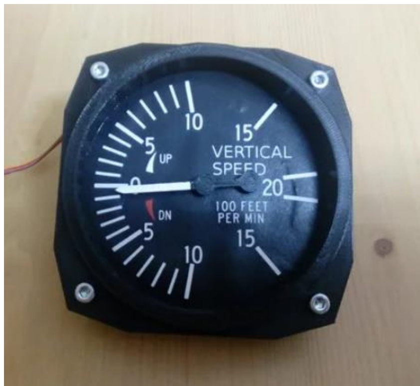
Figura 5.2: Indicador de velocidad vertical impreso en 3D con una impresora doméstica. Fuente " https://www.thingiverse.com/thing:2489322/remixes " (5 de septiembre de 2020).
