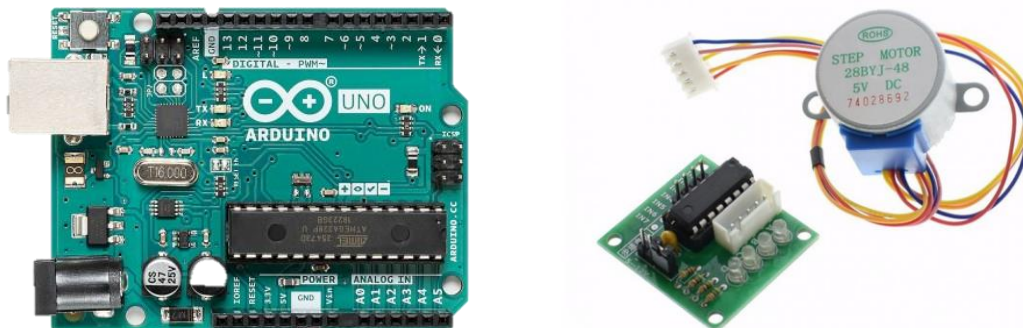
Figura 5.1: Placa programable Arduino, motor paso a paso 28BYJ-48 y controladora ULN2003. Fuente: " https://tienda.bricogeek.com/motores-paso-a-paso/969-motor-paso-a-paso-28byj-48-5v-con-driver-uln2003.html " (5 de septiembre de 2020).
