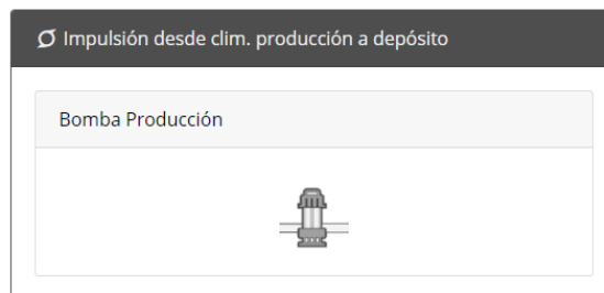
Ilustración 15: Panel que muestra el estado de la bomba de impulsión apagada
