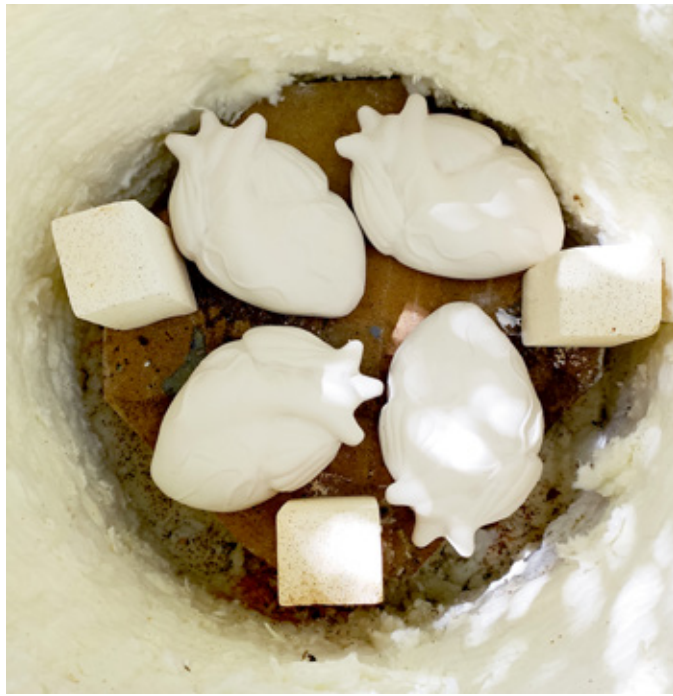
Figura 40. Piezas de porcelana ya cocidas en el horno cerámico
