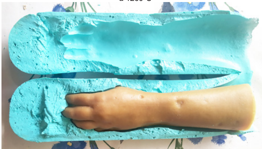
Figura 70. Prueba fallida realizada con cera de abeja y alginato para la obtención del brazo
