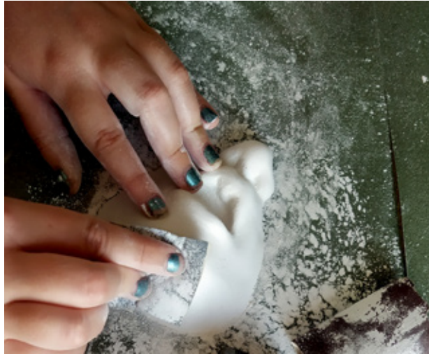
Figura 52. Lijado de las piezas de escayola cerámica
