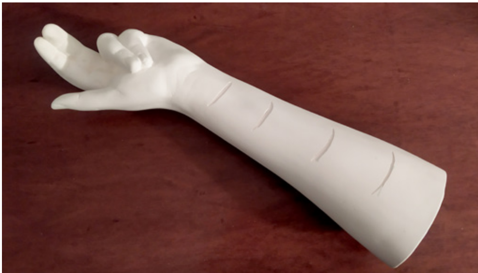
Figura 32. Brazo de porcelana con aberturas para las cuchillas
