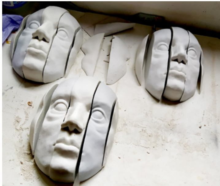
Figura 69. Pruebas del rostro seccionado en porcelana cocida a 1260°C
