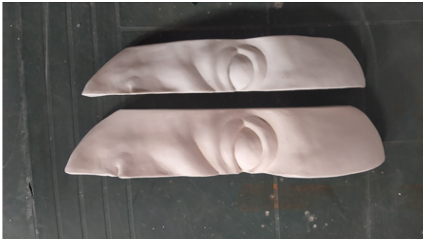
Figura 24. Detalle donde observamos el factor de reducción de la porcelana utilizada. Pieza de menor tamaño, cocida a 1260°C, junto con pieza de mayor tamaño, cocida a 1100°C
