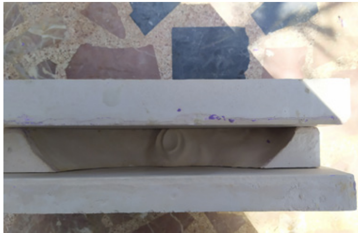
Figura 18. Interior del interior del molde de escayola - negativo de la pieza.
