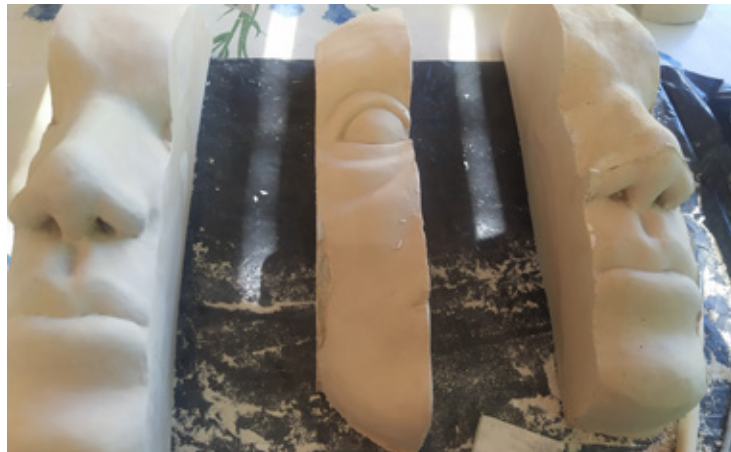
Figura 19. Piezas de porcelana aun cruda recién extraídas de los moldes
