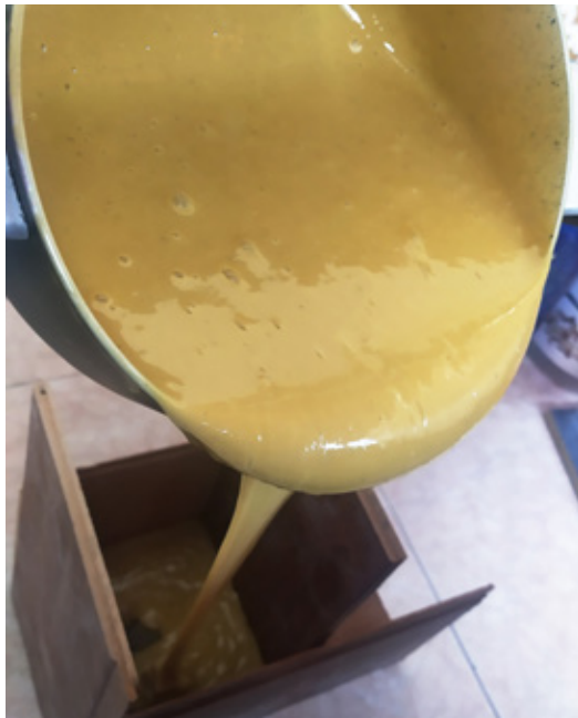
Figura 49. Proceso de elaboración de molde en goma
