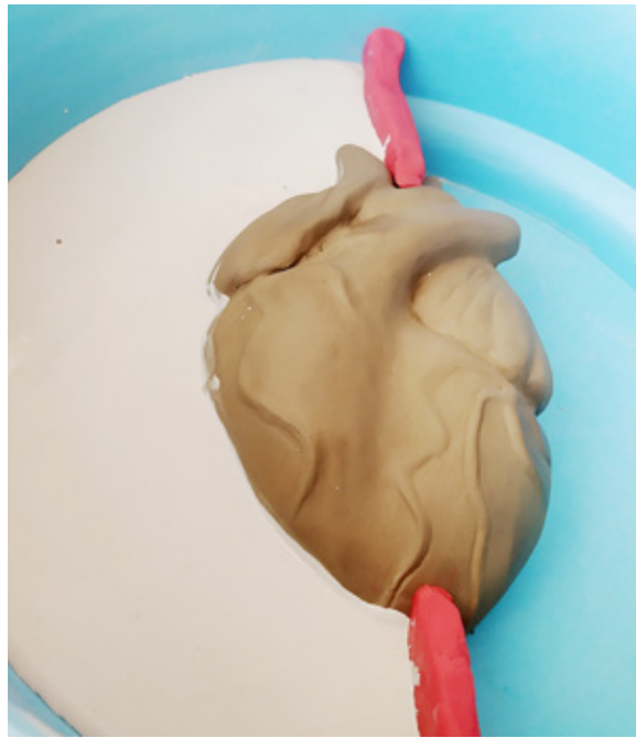
Figura 34. Proceso de creación del molde en dos piezas
