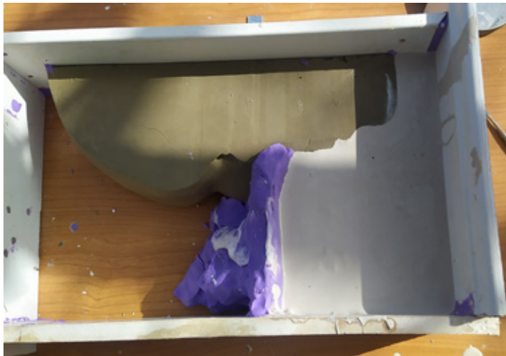
Figura 15. Proceso de realización de molde de escayola en dos piezas
