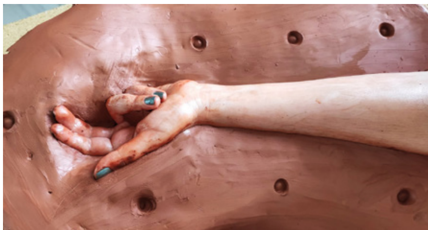
Figura 26. Primer paso en la elaboración del molde de escayola - cama de barro
