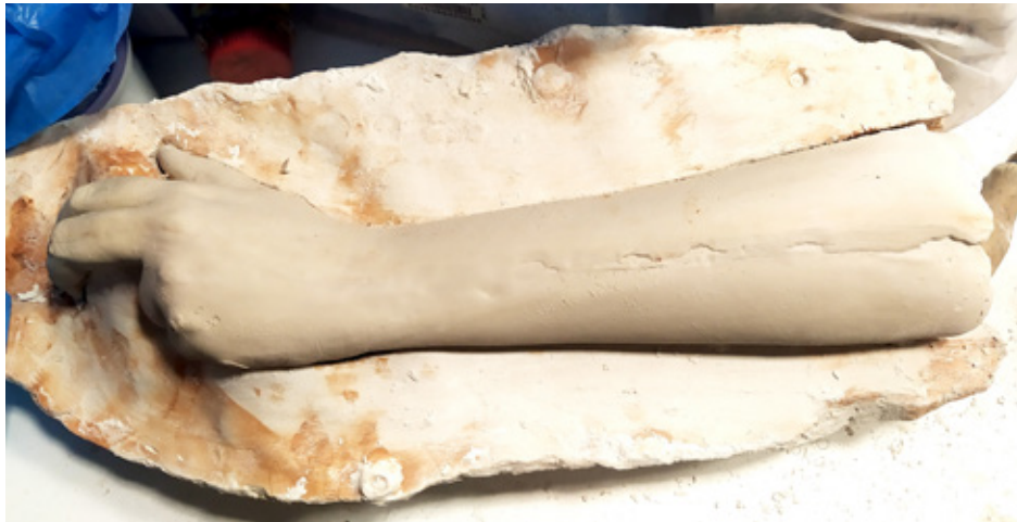
Figura 28. Pieza de porcelana recién abierto el molde
