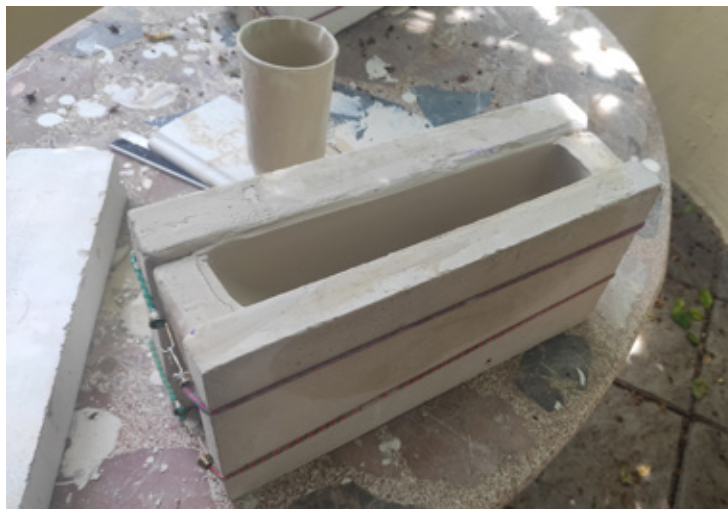
Figura 17. Proceso de vaciado en molde de escayola
