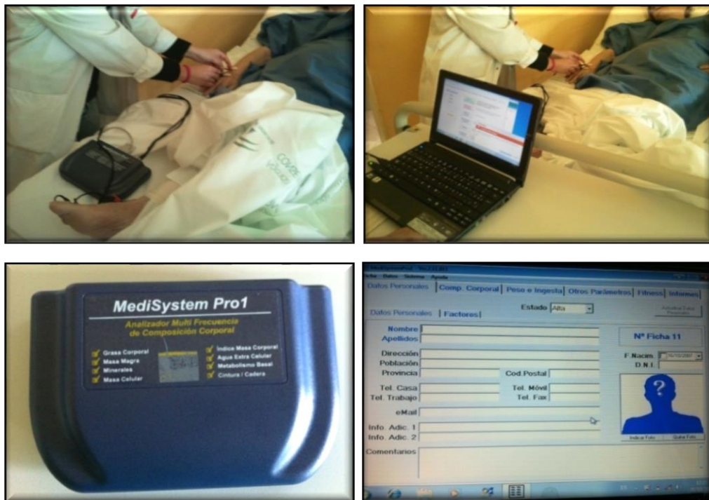
Figuras 10-13: Medición de bioimpedancia mediante sistema Medisystem pro 1 analizador multifrecuencia de composición corporal.
