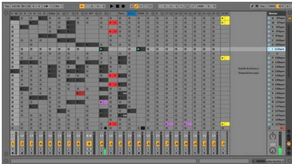
Imagen 61 Vista sesión del programa Ableton en el que pueden verse las partes en las que está dividida esta sesión. Los botones amarillos están configurados para que envíen datos en formato MIDI a v4 mediante OSC. Imagen de elaboración propia.
