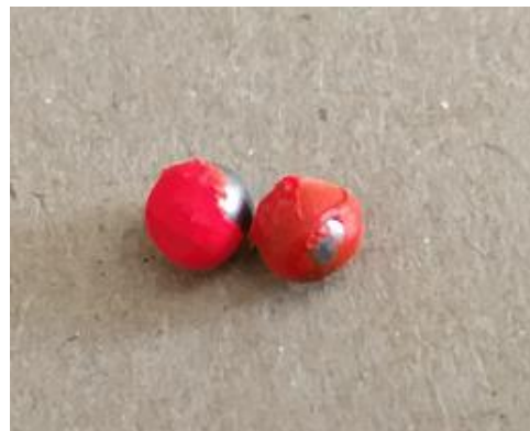
Figura 2.14. Marcadores reflectantes recubiertos de pintura roja empleados en el sistema de videogrametría.
