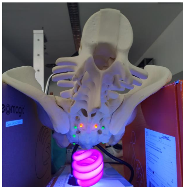
Figura 2.12. Activación de la luz negra sobre el modelo anatómico. Se observan los marcadores reflectantes iluminados.
