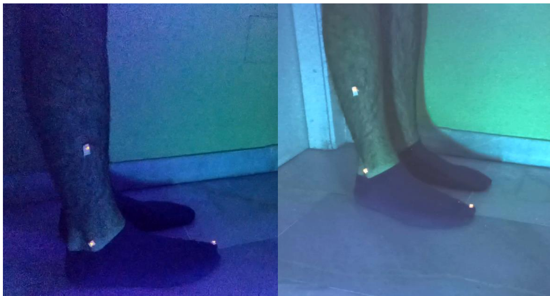
Figura 5.13. Modo de colocación de los marcadores reflectantes para el estudio de la cinemática de la marcha. Un marcador se debe situar en la punta del pie, otro en el tobillo, y el último en el punto medio de la tibia. En la izquierda se observa la imagen obtenida por el dispositivo móvil Xiaomi Mi 8 Lite, mientras que en la derecha se emplea el sistema Redmi Note 8 Pro.
