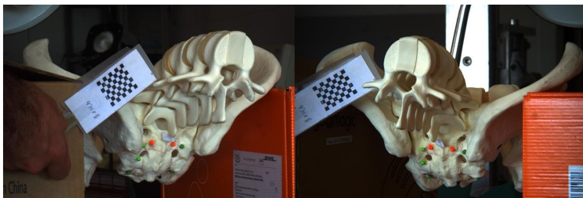
Figura 2.11. Captura de imágenes para la obtención de los parámetros intrínsecos y extrínsecos de las cámaras. Ambas imágenes se encuentran sincronizadas en el tiempo, y hacen referencia a la misma situación, pero están tomadas cada una por una cámara distinta.
