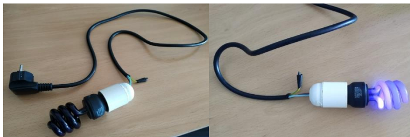
Figura 2.15. Bombilla Velleman de luz negra de 15W empleada en el sistema de iluminación. En la izquierda se observa la bombilla apagada, y en la derecha, ya se encuentra encendida.
