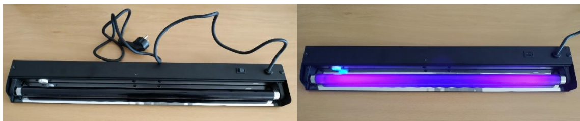
Figura 2.16. Tubo HQ POWER de luz negra de 20W. En la izquierda se observa apagado, y en la derecha ya está encendido.
