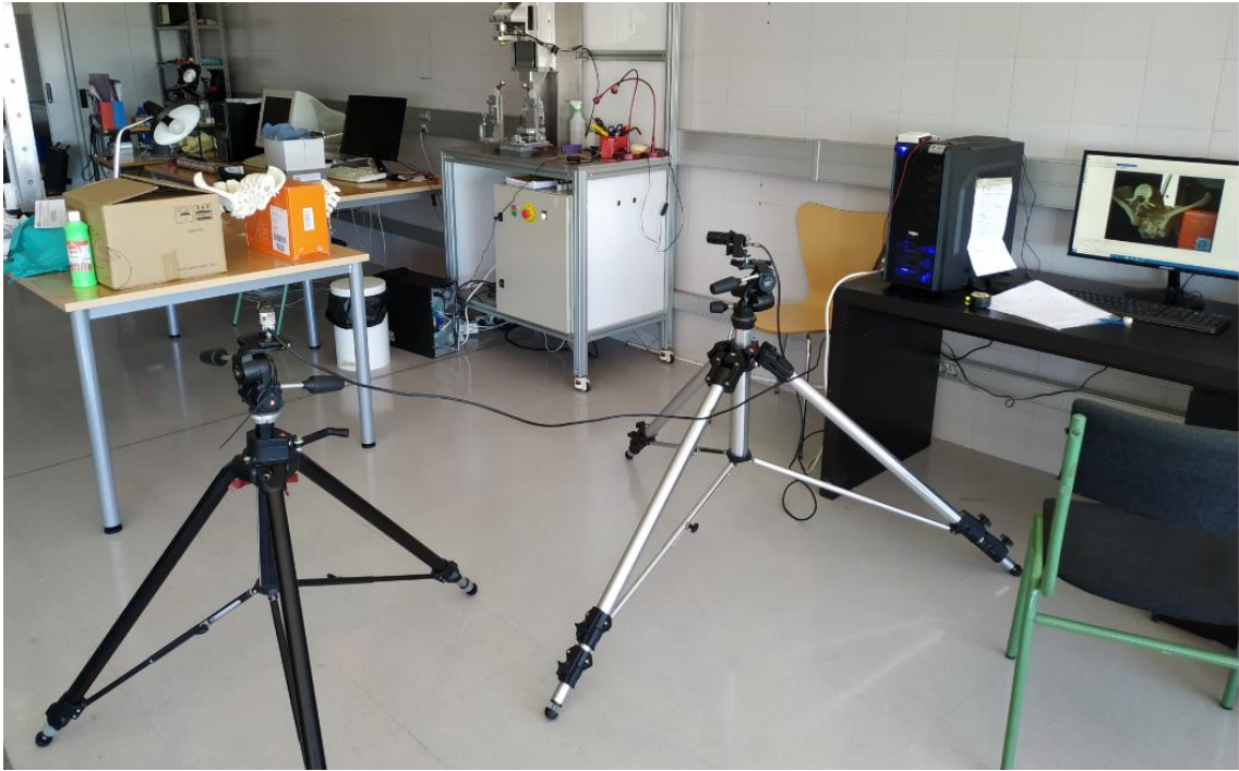
Figura 2.9. Sistema ajustado con las cámaras con sus objetivos posicionadas y orientadas sobre los trípodes, capturando información del modelo anatómico de pelvis y conectadas al ordenador. En la pantalla de este se observa la imagen proporcionada por una cámara.
