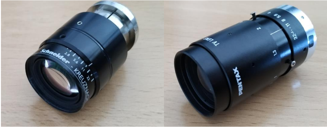
Figura 2.5. Objetivos empleados en el sistema de videogrametría. En la izquierda se muestra el objetivo Schneider Kreuznach Xenoplan, y en la derecha el objetivo PENTAX TV LENS.
