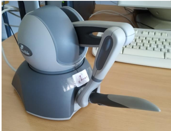
Figura 3.1. Dispositivo háptico Phantom Omni de 3D Systems empleado para la validación de las coordenadas tridimensionales.
