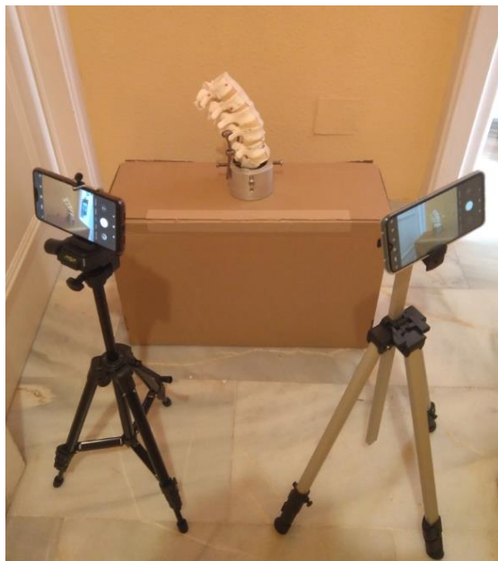
Figura 5.5. Preparación del entorno para la obtención de las imágenes empleadas para conseguir los parámetros intrínsecos y extrínsecos de cada dispositivo móvil.
