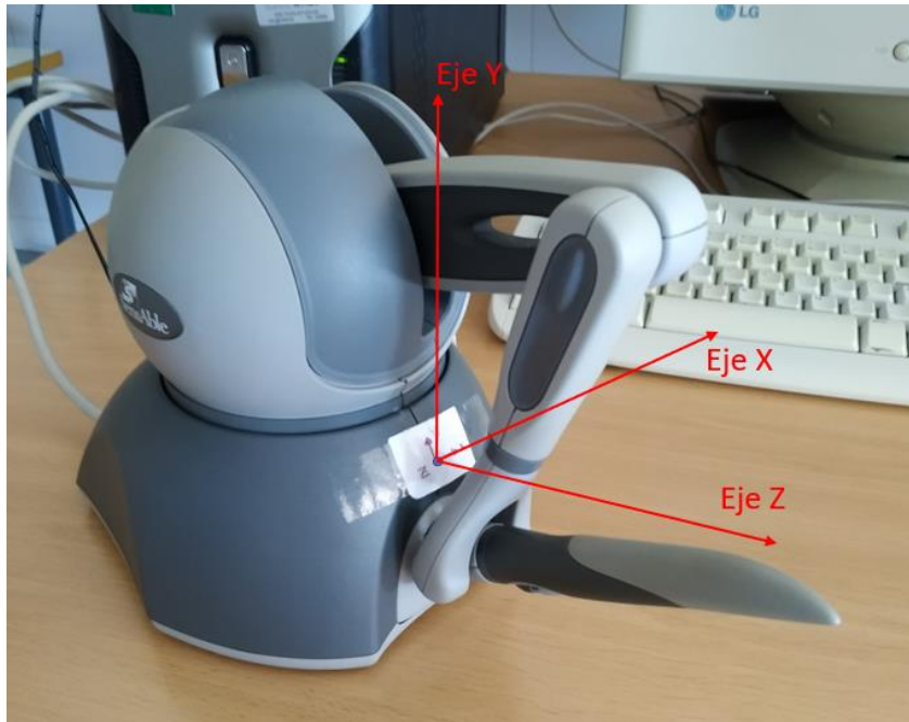
Figura 3.3. Dispositivo háptico Phantom Omni con la dirección y sentido de sus ejes X, Y, Z.
