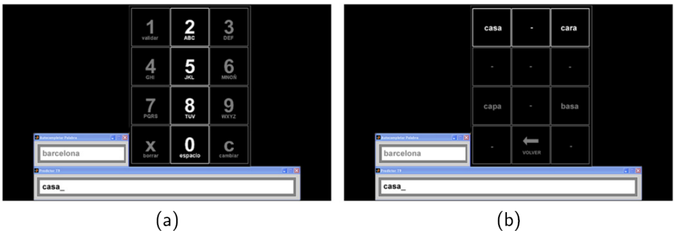
Figure 1. (a) Clavier virtuel basé sur le prédicteur T9 de dimension de 4 x 3. La fenêtre au-dessous du clavier propose le mot de 4 lettres utilisé plus fréquemment selon les touches 2272 (« casa »). Sur la fenêtre de gauche, le système propose un mot plus long et plus fréquemment utilisé et qui commence avec les lettres selon la combinaison 2272 (« barcelona »). (b) Si le mot de 4 lettres proposé par le système (« casa ») ne convient pas au sujet, en sélectionnant la touche C, le système propose d'autres mots.
