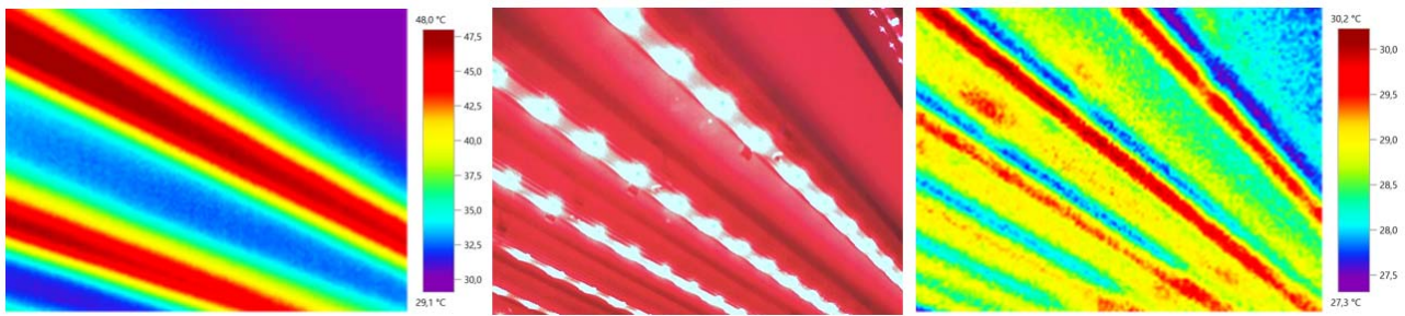
Figura 4. Imágenes Termo gráficas de la temperatura superficial exterior de [Izq] Fluorescentes GroLux [Der] Tubos LED Rojo 660nm
