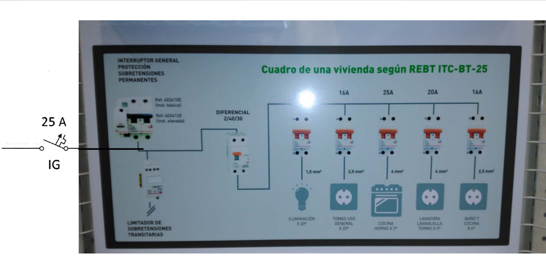
Esquema unifilar de vivienda con grado de electrificación básica
