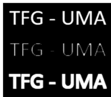
Figura 12: En orden: Imagen original, imagen erosionada e imagen dilatada.
