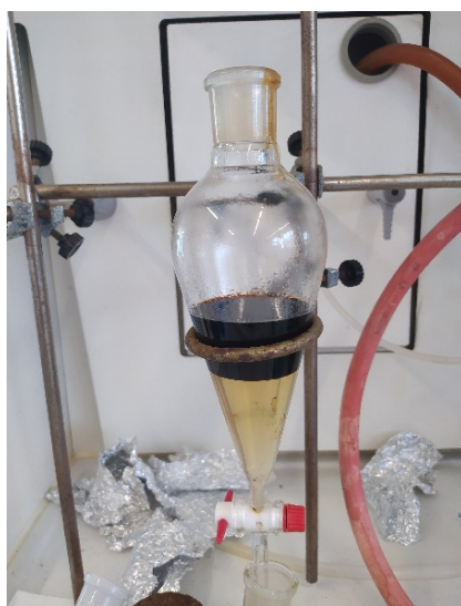
Fig.10. Fase acuosa y fase orgánica superior donde se encuentra el oleato de hierro.
