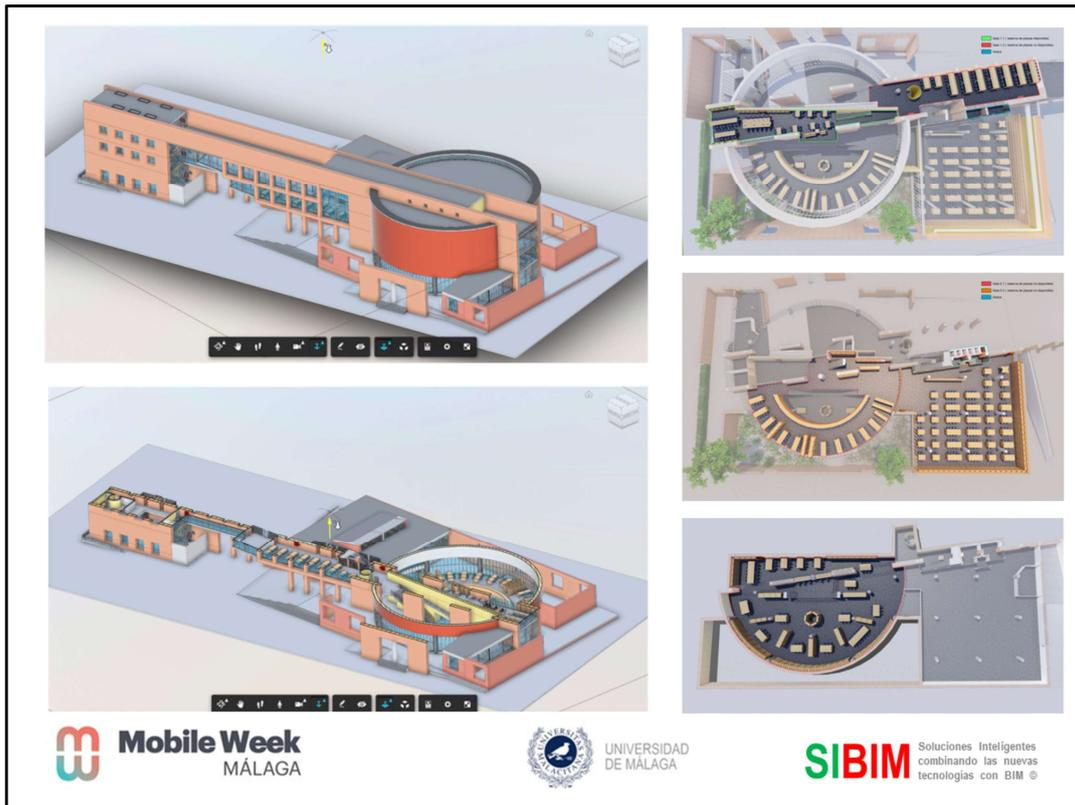
Aquí se pueden observar las vistas de las 3 plantas y de una perspectiva general y otra seccionada, extraídas del modelo BIM que elaboramos de la biblioteca general, desde la interfaz de la plataforma A360 mediante la cual los usuarios pueden consultarlo interactivamente desde sus dispositivos móviles y conocer cualquier aspecto espacial de él sin necesidad de haber sido nunca usuario del edificio.
