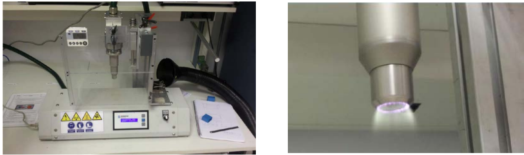
Figura 0.1. Vista general de la instalación del sistema de plasma atmosférico de Plasmatrete GmbH (izda.) y detalle del inyector de rotación Openair® RD1004 (dcha.)
